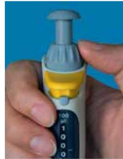
Mudança no ajuste de fábrica visível externamente por uma marca de recalibração
